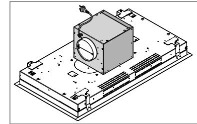
**SE** - Avlägsna flänset från fläkthuven (1) och motor (2). Om luftutloppet är uppåt, se (3). För andra riktningar, se (4) och (5).
