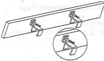
1. Bohren Sie zwei Löcher für die Befestigungsclips.
