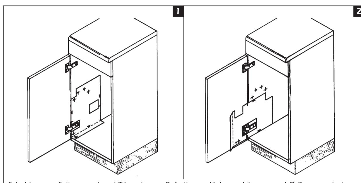
Schablone an Seitenwand und Tür anlegen, Befestigungslöcher ankerboren und Ø 2 mm vorbohren.
